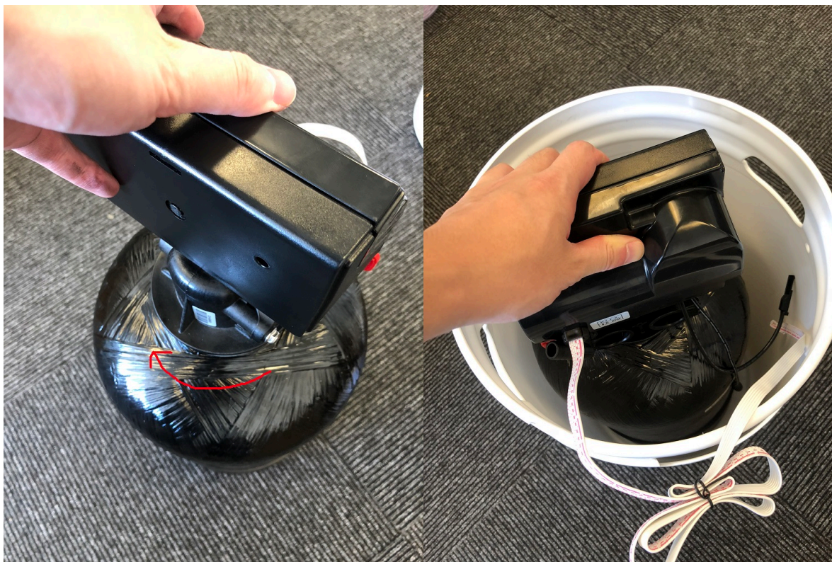
将安装好的控制阀和玻璃钢桶装回外壳
