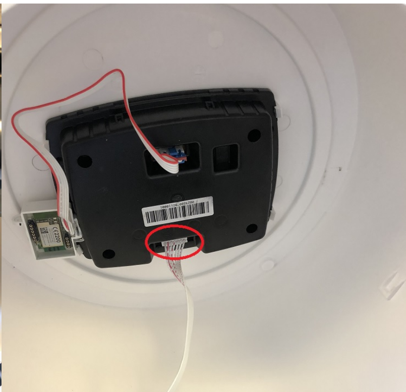
将排线插回显示板，将顶盖装好
